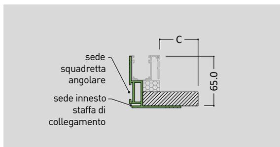
L'applicazione con battuta invertita si ottiene ruotando il profilo. Può essere idonea per soluzioni che prevedono spessori diversi di pannello e/o altre esigenze. Restano immutate la possibilità di inserire una squadretta di montaggio angolare e una eventuale staffa di prolungamento verso l'esterno.
